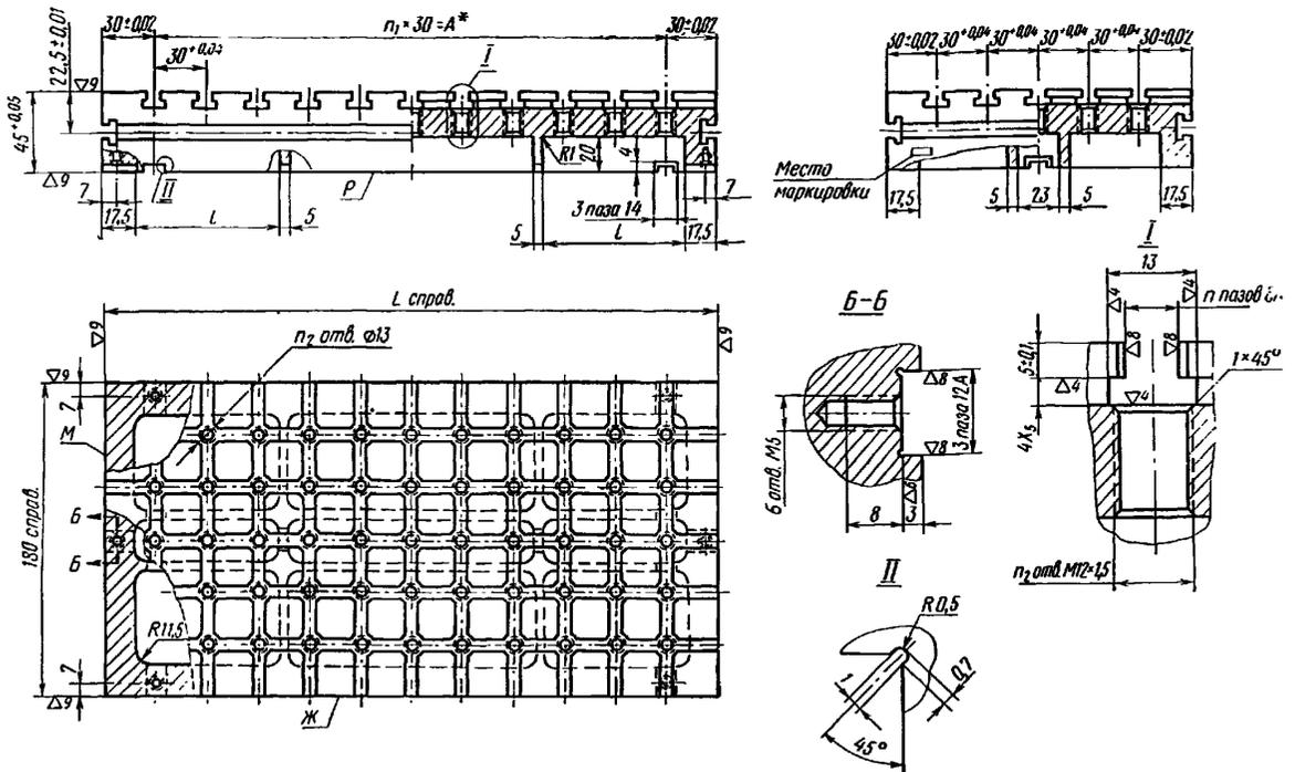
\* Предельные отклонения расстояния между любыми смежными Т-образными пазами  $+0,04$  мм.
